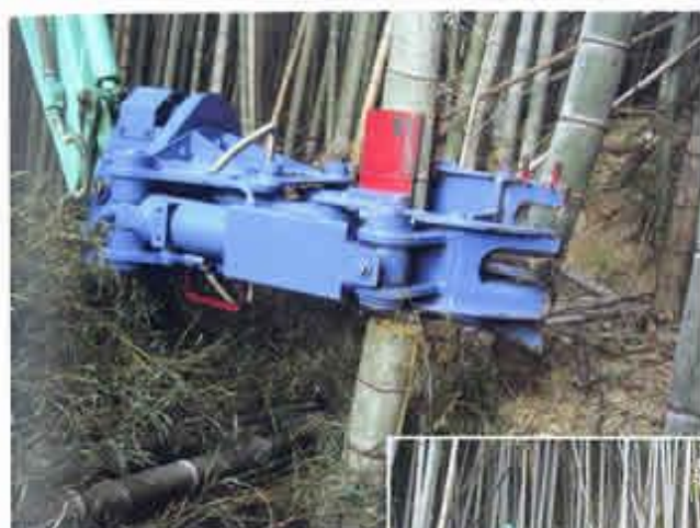
竹キング。小型バックホーに取り付け、竹をつかみながら切断できる
