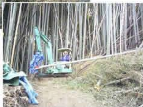
竹キング。小型バックホーに取り付け、竹をつかみながら切断できる
